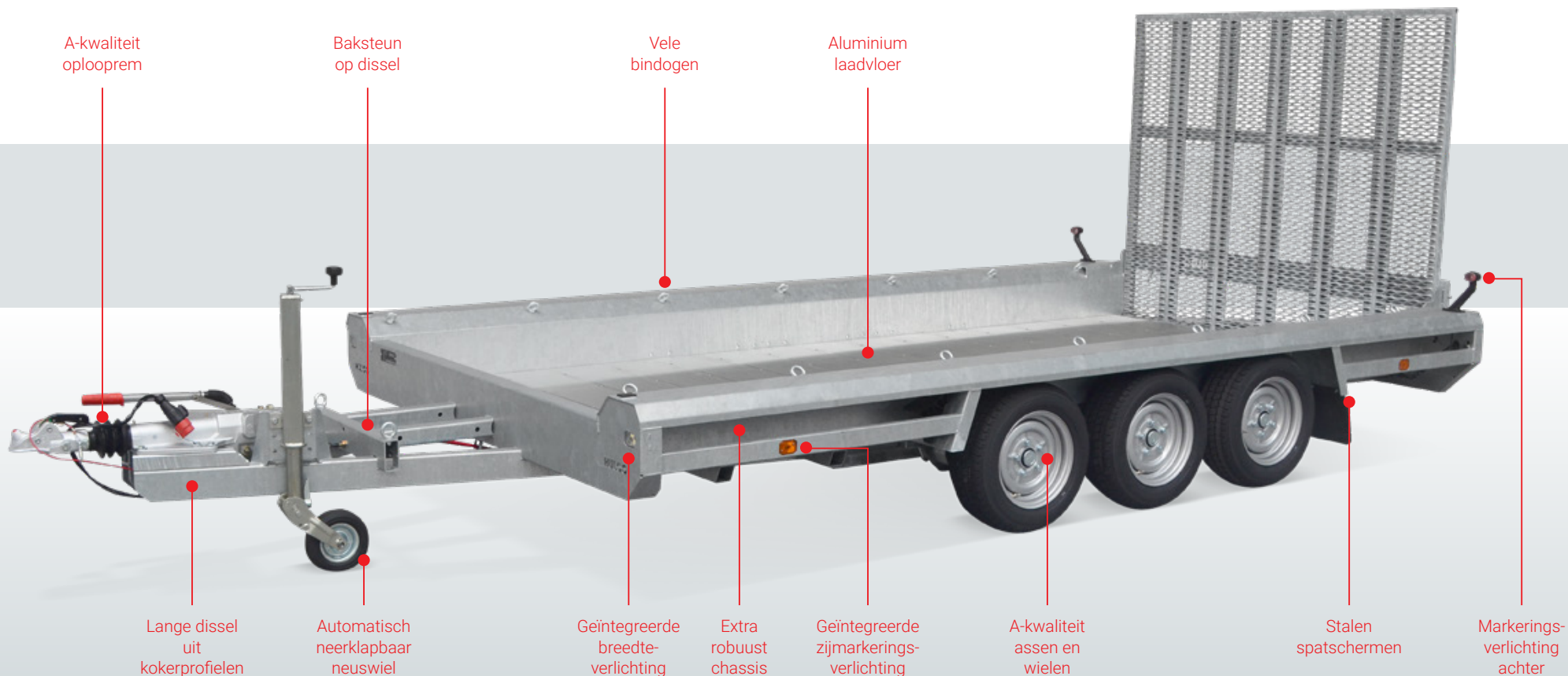
IJzersterke vloerondersteuning door vele kokerprofielen
