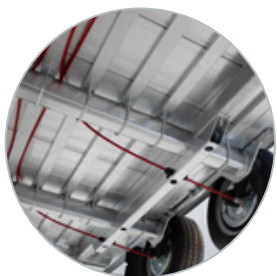
IJzersterke vloerondersteuning door vele kokerprofielen
